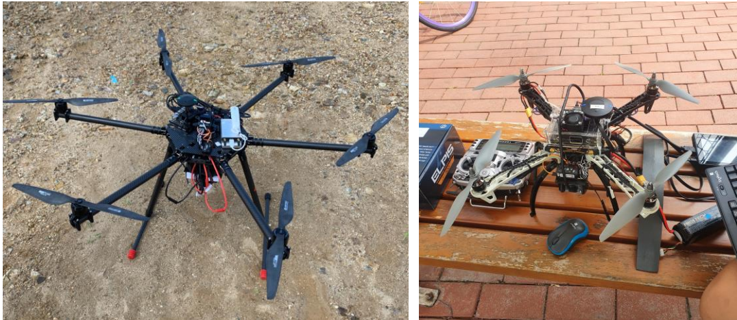
Figure 1. 800급 메인 헥사콥터, 450급 테스트용 기체
