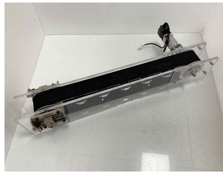
그림 13. Conveyor Belt 실제 모습
