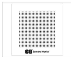
(a) 카메라 교정 calibration chart 0.125mm
